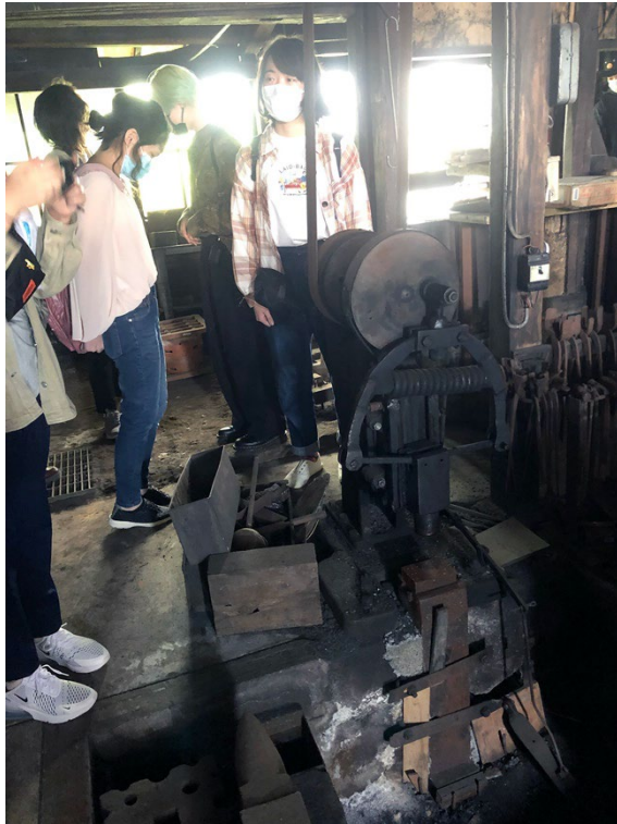
[鍛冶屋工房の見学／右；バネ式鍛造機、左；ベルト式ボール盤]
