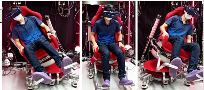
二軸のシリンダ制御によってロール・ピッチ方向に±0.6Gで揺動させることが可能です。
