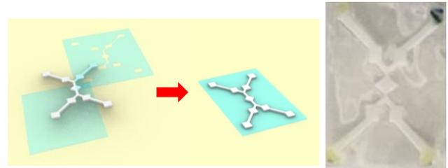
上は、4 種類のアミノ酸濃度を同時計測可能なペーパーマイクロ流路デバイスの作製例である。望みの形状に設計した紙をラミネートフィルムで挟み込むだけで容易に作製可能である (左)。右は 4 種類の aaRS 反応部を有するペーパーデバイスについて計測したところ、検出部の色が青色に変化し、目的のアミノ酸のみが検出・計測可能なことを示している。
