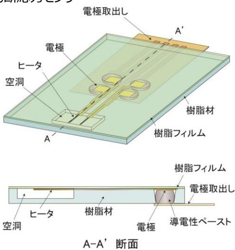
自動車、航空機など、流体中を運動する物体表面に作用するせん断力を計測する熱式 MEMS センサを提案しています。
