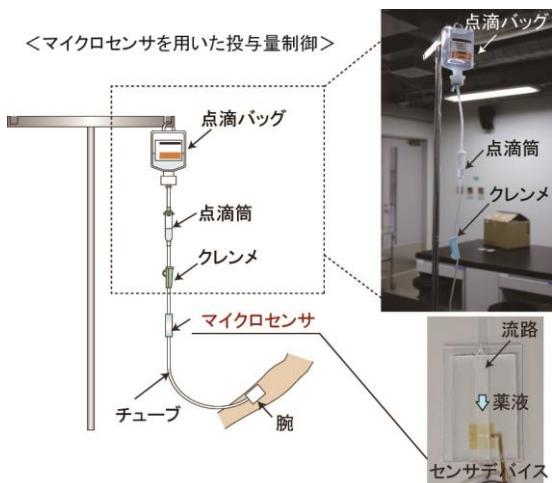
点滴時の投与量計測を可能にする超小型液体用流量センサを提案しています。これを点滴チューブに組込むことで点滴投与量を高精度に制御することが可能になります。
