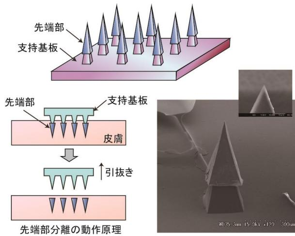
薬剤投与量を高精度に制御でき、かつ瞬時投与が可能な先端分離型マイクロニードルを提案・開発しています（先端部に薬剤を含有）。
