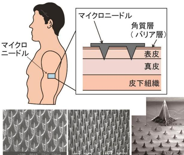
MEMS 微細加工技術を駆使して、微細 Si 製マイクロニードル、更にこれにモールドプロセスを加えた生分解性マイクロニードルを開発しています。
