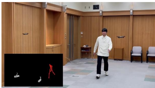
複数台の人物自動追従ドローンによるモーションキャプチャ
