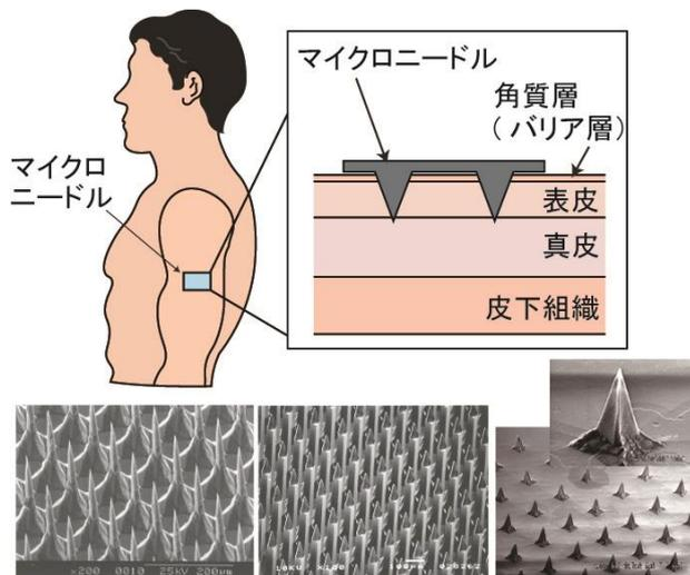
MEMS 微細加工技術を駆使して、微細 Si 製マイクロニードル、更にこれにモールドプロセスを加えた生分解性マイクロニードルを開発しています。
