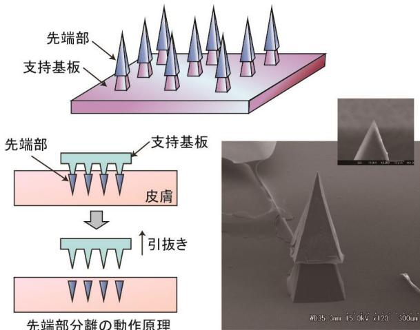
薬剤投与量を高精度に制御でき、かつ瞬時投与が可能な先端分離型マイクロニードルを提案・開発しています（先端部に薬剤を含有）。
