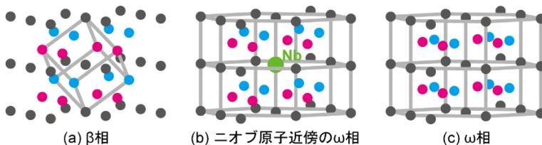
図 1. (a) 一般的な $\beta$ 相、(b) 本研究で明らかになったニオブ原子近傍の $\omega$ 相。 $\beta$ 相に近い構造。(c) 一般的な $\omega$ 相の原子配列。(c)の原子配列をとるべき $\omega$ 相中にもかかわらずニオブ原子近傍では原子配列が $\beta$ 相に近いことが明らかになりました。Acta Materialia **131**, 534-542 (2017) 掲載
