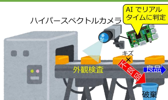
図 1. 良品・不良品の高速判定システムの略図
