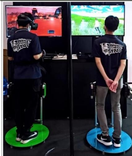
大腿部支持部に載置された荷重センサによって進行方向への歩行動作（体のもたれ具合、足の動き、歩行リズム、歩行バランス等）を推定し、HMD 等の視覚ディスプレイを介して歩行動作に応じた映像を呈示することにより、簡易な仕組みで歩行感覚を定位置で呈示することが可能です。
