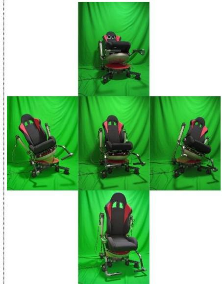
大径球面体上の積載物を転がすことで積載物の重心が下がり、起き上がりこぼしのように、転がしても元に戻ろうとする復元力が働きます。これにより、簡易な仕組みで積載物を少ない力（150W）で大きな揺動（ロール・ピッチ方向に±26°、±1.0G、疑似6軸で制御可能）
