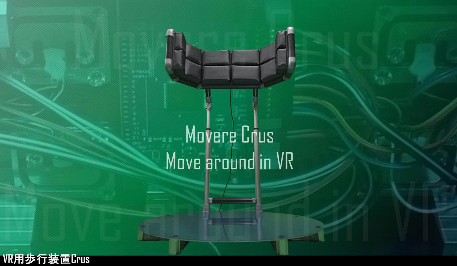
ユーザの進行方向に大腿部を支持し,歩行動作に応じて映像を変化させることによってWR空間内の歩行移動を錯覚させる, これまでにない新しいタイプのWR歩行装置を提供致します(歩行感覚呈示装置および呈示方法,日本国特許第6795190号,中国特許番号ZL 201880015009.6,米国登録番号H.DBI.DND))。
