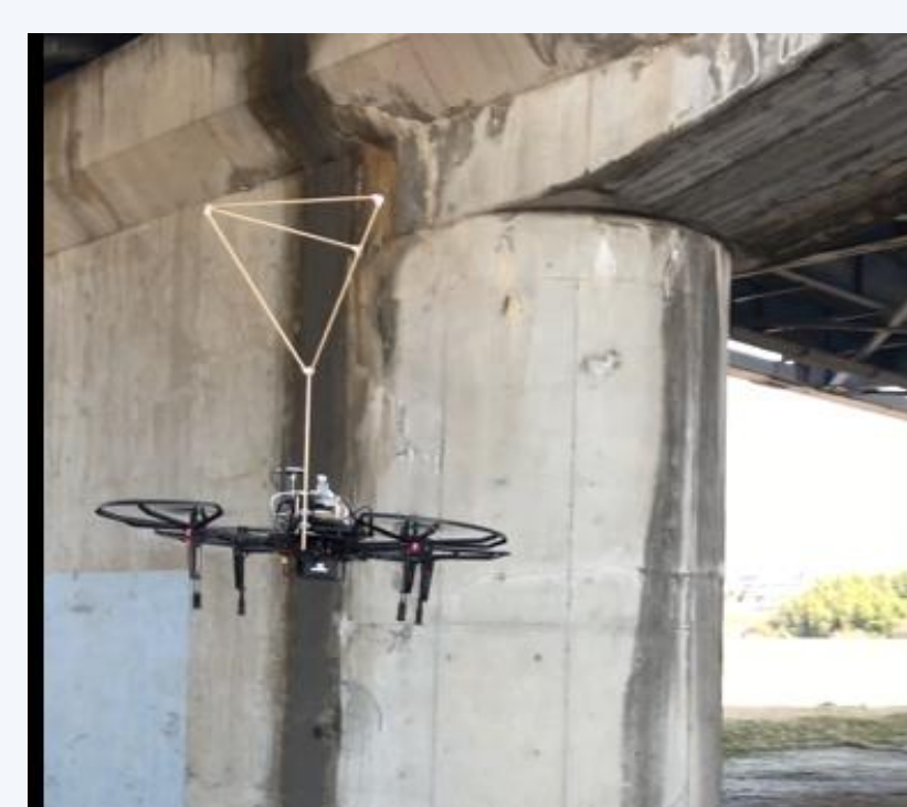
ドローンによるコンクリート表面のひび割れ検出
