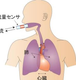
人体構造的に、呼吸器は骨で仕切られた胸郭内に心臓や大血管などとともに収められ、その結果、呼気の流れには、呼吸器機能を反映する換気量以外に、心臓や大動脈における拍動運動の頻度及びその容量変化を示す情報も含まれます。そこで、本テーマでは、口元の呼吸流れにより、呼吸および循環（心拍）に伴う様々な物理情報を読取る計測技術の実現を目指しています。
