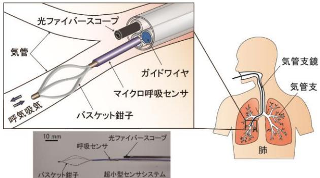
MEMS 技術を用いて、末梢気道内にて呼気吸気計測が可能な超小型カテーテルセンサシステムを開発しています。これにより、病変部位におけるその場呼吸機能計測を低侵襲で計測評価できるシステムの実現を目指します。本デバイスの実現により、医学的に未知なる領域とされている末梢気道での呼気吸気特性の解明に挑戦します。
