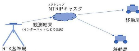
また、高精度衛星測位の一つである RTK 補強情報を公開しています。RTK は、座標の既知な基準局での電波観測結果を利用するものです。広島市立大学の NTRIP キャスターと公開 RTK 基準局は、誰でも、無料で、事前連絡なしに利用できます。RTK は基準局から半径 10 km 程度のエリアで利用可能です。
