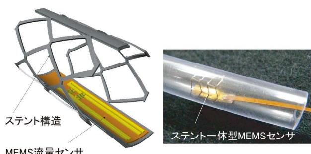
本テーマでは、MEMS 加工技術を金属板上に展開することで、機械的強度に長けた金属製構造体（ステント）と MEMS センサデバイスとの一体化を可能にします。
