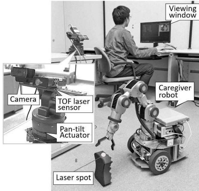
図 1. 教示用インターフェースと支援ロボットの例
