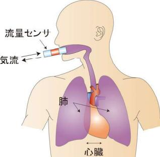
人体構造的に、呼吸器は骨で仕切られた胸郭内に心臓や大血管などとともに収められ、その結果、呼気の流れには、呼吸器機能を反映する換気量以外に、心臓や大動脈における拍動運動の頻度及びその容量変化を示す情報も含まれます。そこで、本テーマでは、口元の呼吸流れにより、呼吸および循環（心拍）に伴う様々な物理情報を読取る計測技術の実現を目指しています。
