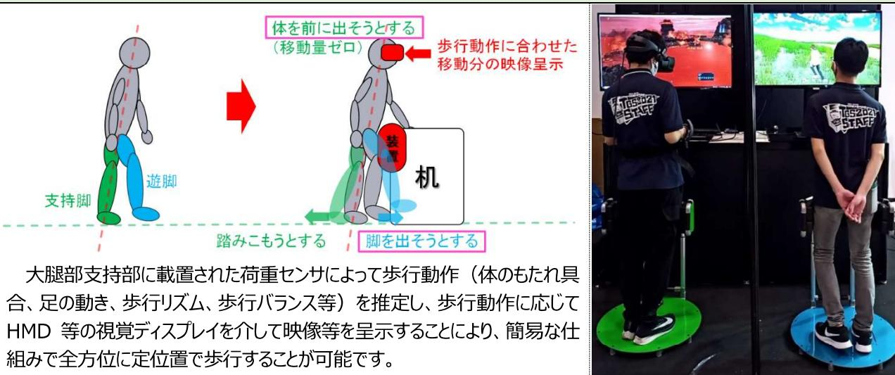
大腿部支持部に載置された荷重センサによって歩行動作（体のもたれ具合、足の動き、歩行リズム、歩行バランス等）を推定し、歩行動作に応じてHMD等の視覚ディスプレイを介して映像等を呈示することにより、簡易な仕組みで全方位に定位置で歩行することが可能です。
