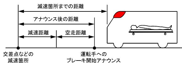
減速箇所までの距離測定、ブレーキ開始タイミングの計算、音声アナウンスまで 1 台の iPhone で完結できます
