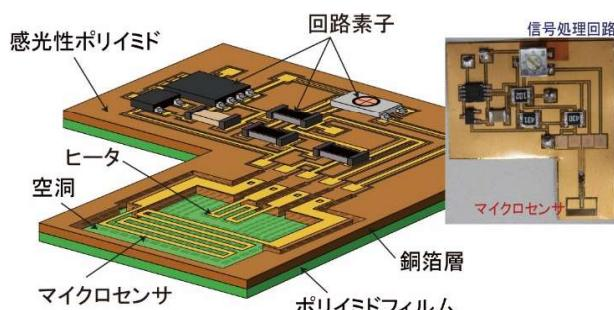
本テーマでは、銅張積層版を MEMS 基板として導入することで、ポリイミドフィルム（樹脂材）上での MEMS センサと回路素子との集積化を可能にします。
