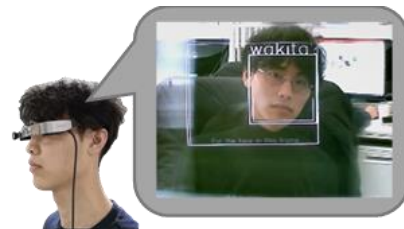
目の前の人の名前が分かる人物認識ウェアラブルシステム
