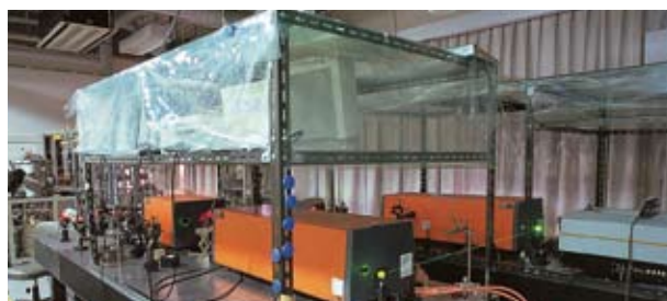
レーザー二重共鳴装置 創造科学専攻 原子や分子に2つの波長の異なるレーザーを照射し、光応答性から電子励起状態の化学的性質を解析します。
