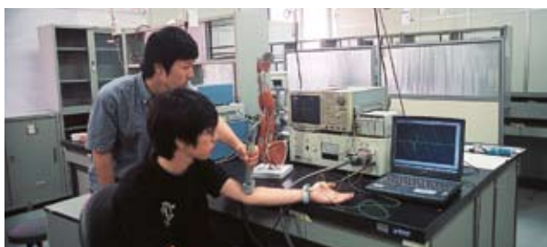
神経磁気刺激装置 創造科学専攻 パルス磁場により生体内に電界を誘導し、脳や神経を非接触・非侵襲的に刺激する装置です。刺激により誘発される筋電図等の生体反応を解析することにより脳や神経の機能を詳しく調べることができます。
