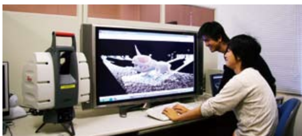
3次元モデル生成・表示システム 知能工学専攻 デジタルカメラやレーザー計測器を使って得た実物大のデータを解析して3次元形状と表面反射特性を推定し、CG技術を使って実物体を高精細に再現するシステムの研究開発を行っています。
