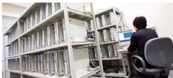
大規模 PC クラスタ 知能工学専攻 PC クラスタは複数のパソコンをネットワークで接続したシステムです。128 台のパソコンで構成される PC クラスタを用いて、大規模な計算やデータ処理の並列化に関する研究を行っています。
