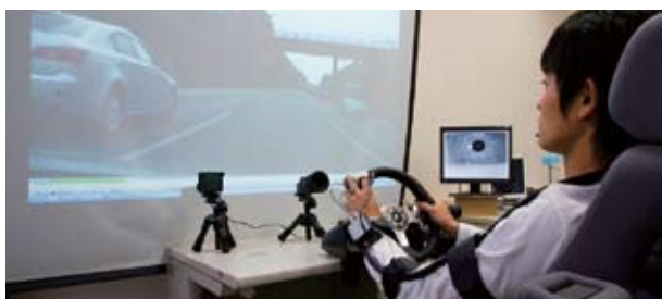
血圧と眼球運動測定装置 システム工学専攻 運転中に、運転者の血圧変化や眼球運動を計測できる実験装置です。リアルタイムの生体情報と車の運転を結びつけることで、救急車や福祉車両内の患者の血圧変動を少なくする運転方法のガイドライン作りや、居眠り運転・脇見運転等を防止する車両の開発など、多様な分野への展開を追求します。
