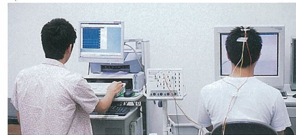
脳波解析装置 頭部の定められた位置に電極を装着し、基準電極との電位差により脳波を測定します。脳波計から脳波データをパソコンへ取り込み、周波数分析、カオス解析等を行います。
