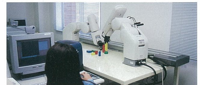
能動認識システム 視覚 (ビデオカメラ) と触覚 (ロボットアーム) の協調によって、3次元物体の形状と属性を能動的に認識する人工知能システムの研究開発を行っています。
