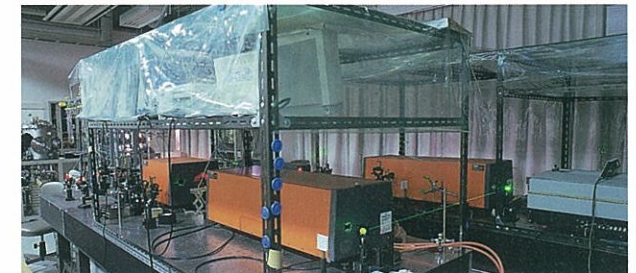
レーザー二重共鳴装置 原子や分子に 2 つの波長の異なるレーザーを照射し、光応答性から電子励起状態の化学的性質を解析します。
