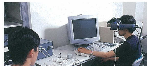
仮想現実空間を使った遠隔操作実験 仮想空間内にある装置を“仮想の手”を使って操作する実験です。“仮想の手”と“操作者の手”、宇宙空間や深海底に置いた装置と仮想空間内の装置をそれぞれ連動することで、“手”を使った遠隔操作が可能になります。
