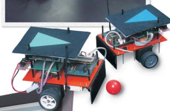
3年次に行うシステム工学実験Ⅰ・Ⅱでは、電気電子回路・ヒューマンインタフェース・画像処理・制御工学等の各要素技術を統合し、マイコンを搭載したロボットを自律走行させるシステムを製作します。
