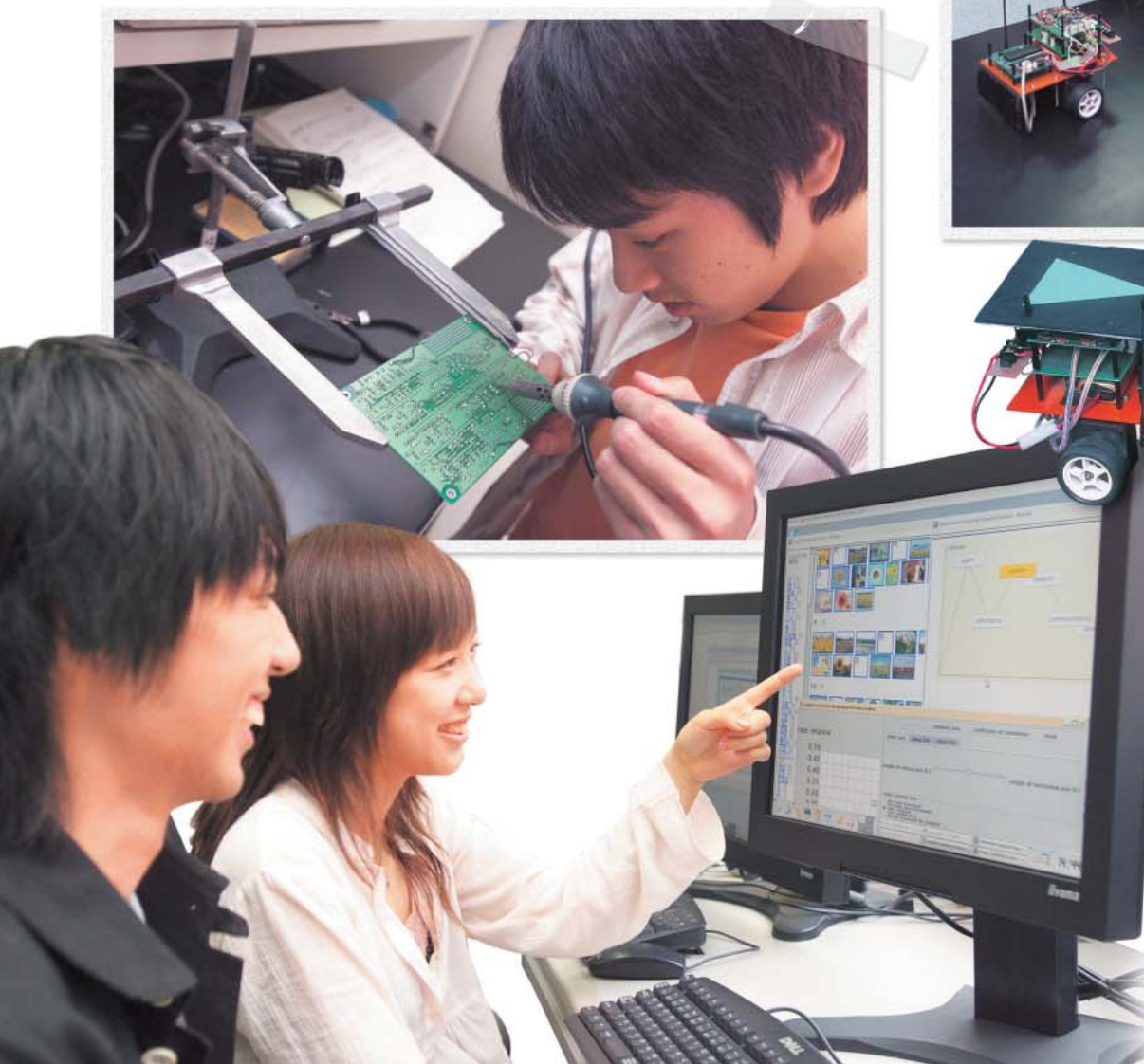
3年次に行うシステム工学実験Ⅰ・Ⅱでは、電気電子回路・ヒューマンインタフェース・画像処理・制御工学等の各要素技術を統合し、マイコンを搭載したロボットを自律走行させるシステムを製作します。
